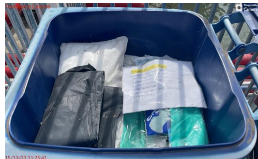
ภาพที่ 3 เครื่องมือและอุปกรณ์ดูดซับน้ำมัน
